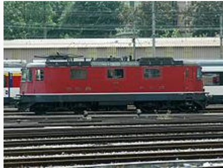
SBB Re 4/4 II 11101 in Basel (Prototyp, u.a. erkennbar an der weiter unten angebrachten Beschriftung)
